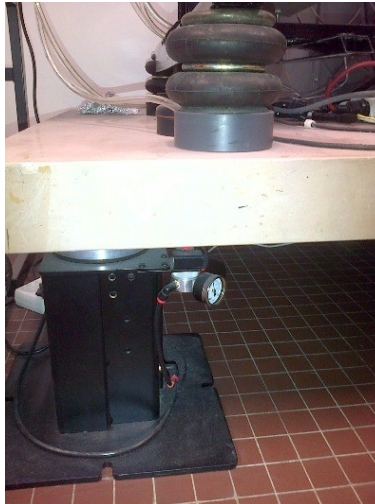
Figure 23: système d'amortissement des vibrations venant du sol : dans la partie inférieure de l'image, on distingue l'un des quatre pied TMC supportant le marbre et dans la partie haute l'un des pieds Firestone supportant le bâti
