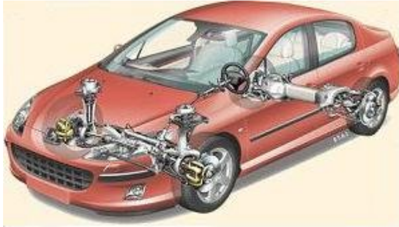
FIG. 1.1: Vue par transparence des éléments constitutifs d'une LAS.
