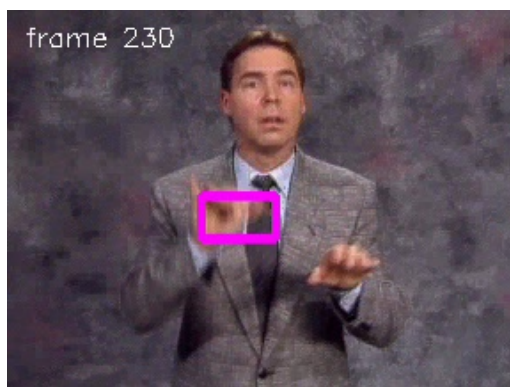
FIGURE 3.3 – Exemple d'estimation de la position de la main dominante avec un filtre particulière en utilisant une représentation rectangulaire
