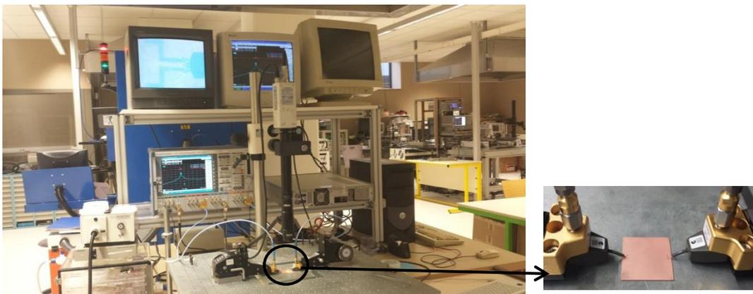
Figure IV-13: Banc de mesure des résonateurs
