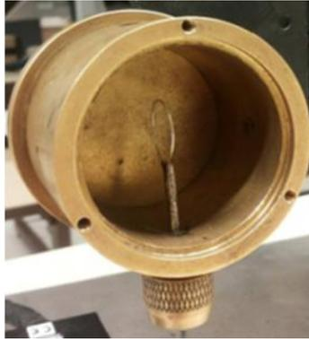
Figure III-7: Photographie de la cavité sans résonateur diélectrique
