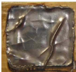
Figure 3.18- Fusion du dépôt de gallium et nickel à 400°C
