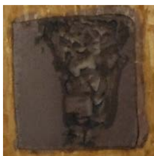
Figure 3.12- Formation de dendrites après changement d'électrolyte à la concentration de 0.5 mol/L en sulfate de gallium et chlorure de nickel
