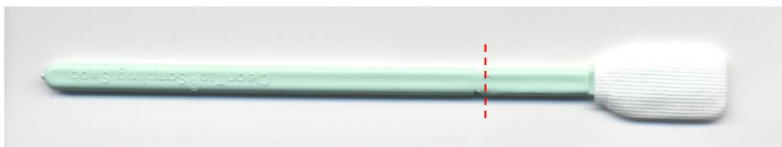
Figure 2.5 : Ecouvillon TX715 ® Large Alpha Sampling Swab utilisé pour l'écouvillonnage de surface (en pointillé rouge : barre de sécabilité)
