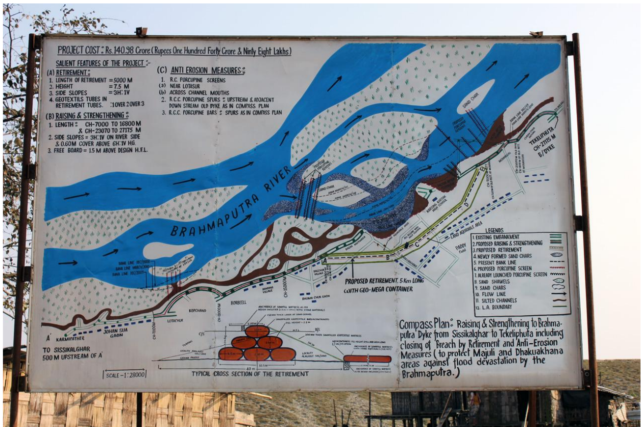
Photo 23 : Panneaux présentant le projet de construction de la digue : « Plan de construction : construction et renforcement de la digue de Sisikalghar à Tekeliputha comprenant le colmatage des brèches par des mesures anti-érosives, afin de protéger les secteurs de Majuli et de Dhakuakhana contre les inondations dévastatrices du Brahmapoutre ».
