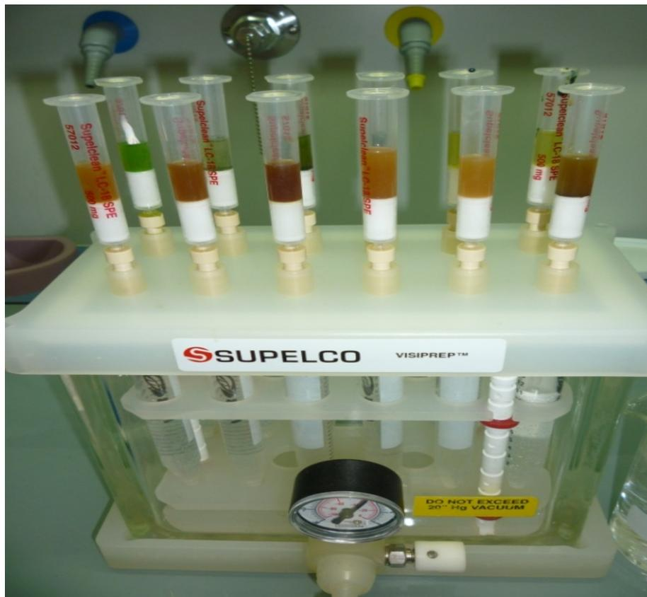
Figure 26. Appareillage permettant de suivre 12 minicolonnes Supelclean SPE.
