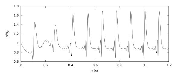
Figure FR6: Evolution temporelle de l'épaisseur du film normalisé avec l'état uniforme. Nombres adimensionnés :  $Re_1 = 4.48$ ,  $Re_2 = 36.8$ ,  $We = 2 \cdot 10^{-3}$ . Gradient de pression et cisaillement uniforms :  $G_0 = -\Delta p/L = 2461.5 \ Pa \ m^{-1}$ ,  $\tau_{i0} = 0.32 \ Pa$ .
