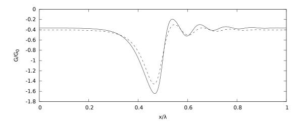
Figure FR9: Évolution spatiale du gradient de pression. Comparaisons entre le modèle double St. Venant de Dietze & Ruyer-Quil (ligne en pointillés), Figure 8(b) de [25], et SWANS (ligne en traits pleins). La description des paramètres physiques se trouve dans la Figure FR6.
