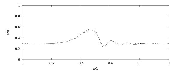
Figure FR7: Épaisseur du film dans la conduite. Comparaisons entre la DNS de Dietze & Ruyer-Quil (ligne en pointillés), Figure 7(a) de [25], et SWANS (ligne en traits pleins). La description des paramètres physiques se trouve dans la Figure FR6.
