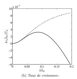
Figure FR3: Solution de la relation de dispersion pour un film d'eau-glycerine tombant le long d'un plan incliné de  $\beta=6.4^{\circ}$ . Nombres adimensionnés : Re=8.5, Fr=0.316, We=0.048. Courbes avec tension de surface (ligne en traits pleins) et sans (ligne en pointillés).
