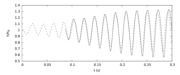
Figure FR10: Évolution temporelle de l'interface après décalage de la solution SWANS. Comparaison entre la DNS de G. Blanchard avec le code Slosh (ligne en pointillés), et SWANS (ligne en traits pleins). Nombres adimensionnés :  $Re_1 = 16.5$  et  $Re_2 = 1972$ . État uniforme :  $\tau_{i0} = 0.03$  Pa,  $u_0|_h = 0.15$  m  $s^{-1}$ .
