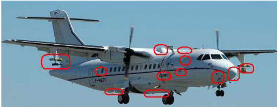
Figure 2.5 : Photo de l'ATR-42 lors d'un vol de recherche lors de la campagne EUCAARI-IMPACT de mai 2008. Les rectangles indiquent la localisation des différents capteurs installés à l'extérieur de l'avion. (Source : http://www.pa.op.dlr ).
