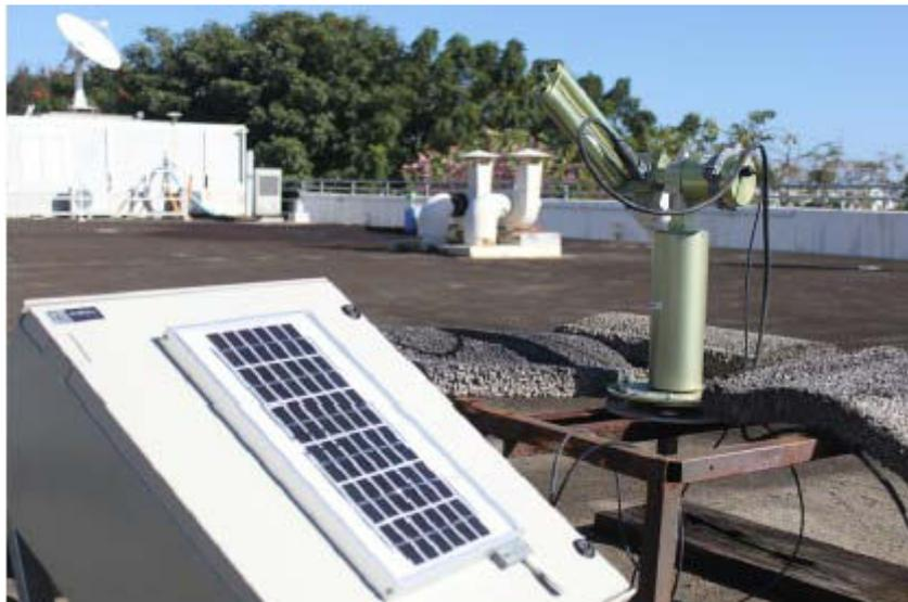
*Figure 2.1 : Photo du photomètre CIMEL de la Réunion*
