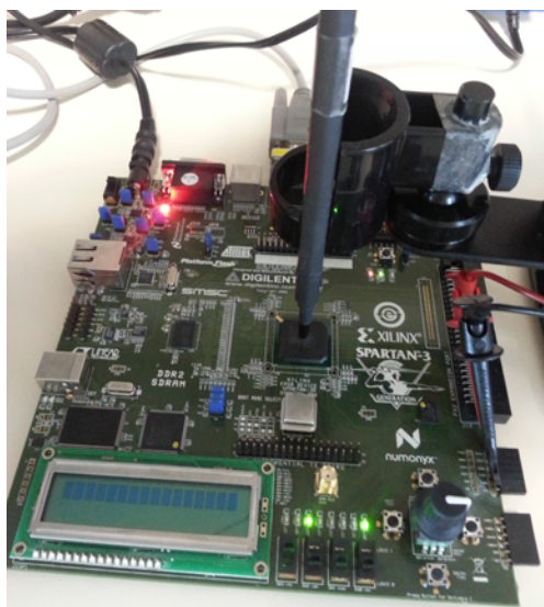
Figure 8 : Sonde EM au contact d'un FPGA
