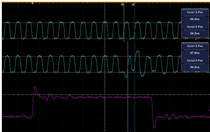
**Figure 12** : Capture d'oscilloscope d'un glitch d'horloge
