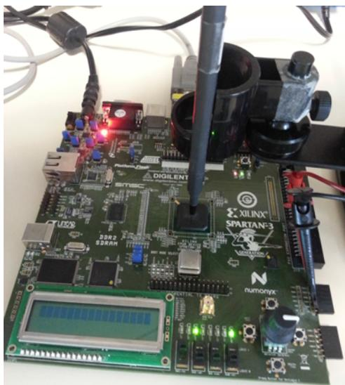
**Figure 8** : Sonde EM au contact d'un FPGA
