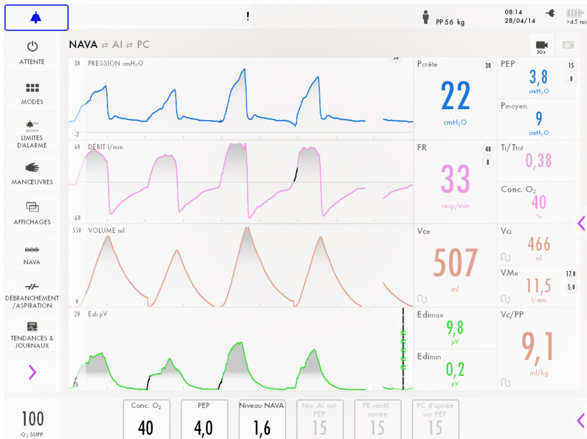
Cette figure 39 illustre le mode NAVA avec la synchronisation de la ventilation sur l'EAdi, les 3 premiers cycles ont un déclenchement électrique alors que le quatrième a un déclenchement pneumatique suivi immédiatement de l'EAdi. La ventilation en bleu est proportionnelle intra cycle à l'EAdi en vert avec un niveau NAVA de 1,6 cmH 2 O/ μvolts.
