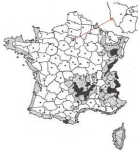
Figure 1.11 : a) carte de France des zones de gel b) profondeur de fondation recommandée en France (Renaud, 2010)
