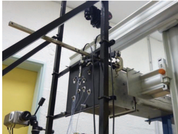
Figure II.4 : Appareils de mesures utilisés. (microphones, tête laser, caméra,...)
