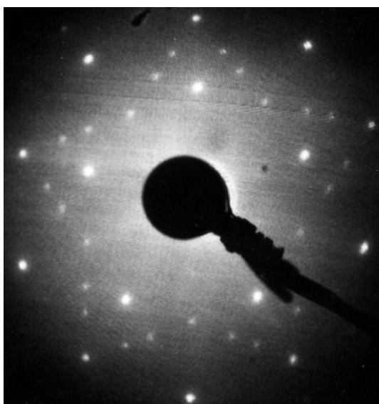
Figure III-5 : LEED obtenu après recuit à 600K. A 85 eV, on observe un cliché de symétrie pentagonale, compatible avec la structure icosaédrique du quasicristal AlPdMn.
