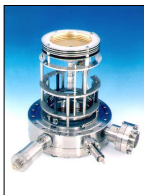
Figure II-13 : Image du LEED. Dans la Figure II-14, le LEED est monté dans la chambre et on en voit l'écran derrière le porte-échantillon
