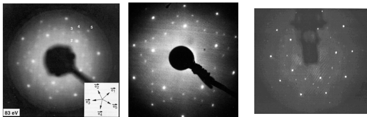
Figure VI-3 : Trois clichés de diffraction d'électrons lents de symétrie cinq, observés sur la surface du quasicristal AlPdMn. A gauche : cliché de T. Schaub à 83 eV, sur un échantillon polycristallin tiré par M. de Boissieu (Grenoble). Au centre un cliché obtenu par nous même sur un monograin produit à Grenoble et coupé suivant une surface cinq (énergie des électrons : 84 eV). A droite un cliché de Z. Shen (énergie des électrons : 80 eV) sur une surface cinq coupée d'un monograin tiré par T. Lograsso (Ames).
