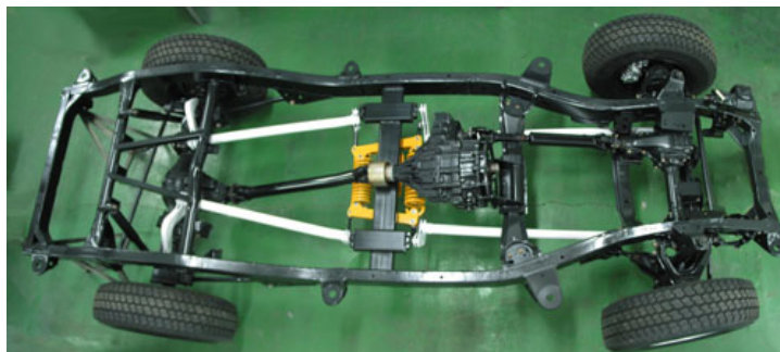
FIGURE 1.13 – Implantation mécanique de la suspension CREUAT
