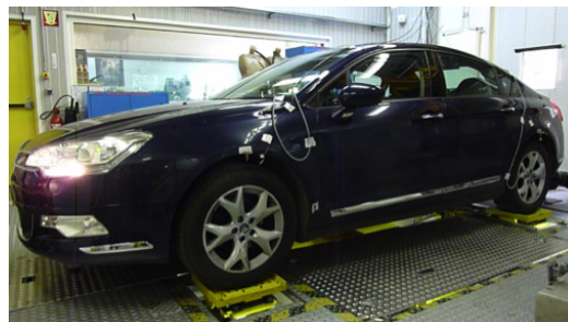
FIGURE 1.22 – Véhicule Citroën C5 lors de tests sur un banc quatre vérins
