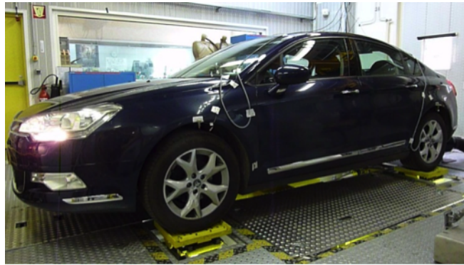
FIGURE 3.9 – Véhicule Citroën C5 lors de tests sur un banc quatre vérins
