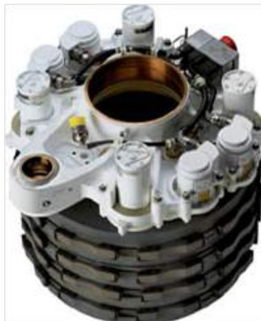
FIGURE 1.12 – Dispositif de freinage utilisé dans l’aéronautique
