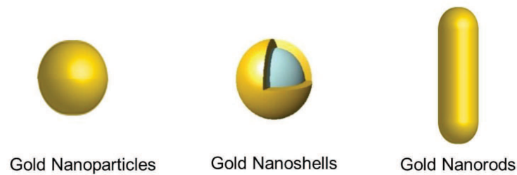
Figure I.11 – Représentation schématique de nanoparticules d'or typiques. [Oberleitner, 2013]
