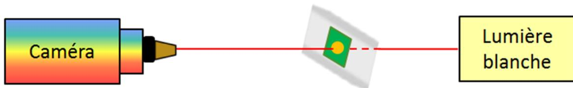
FIGURE 2.2 – Dispositif expérimental : le sore est fixé sur une lame de verre mobile. Il est éclairé par une lampe et filmé par une caméra couleurs munie d'un objectif de microscope.
