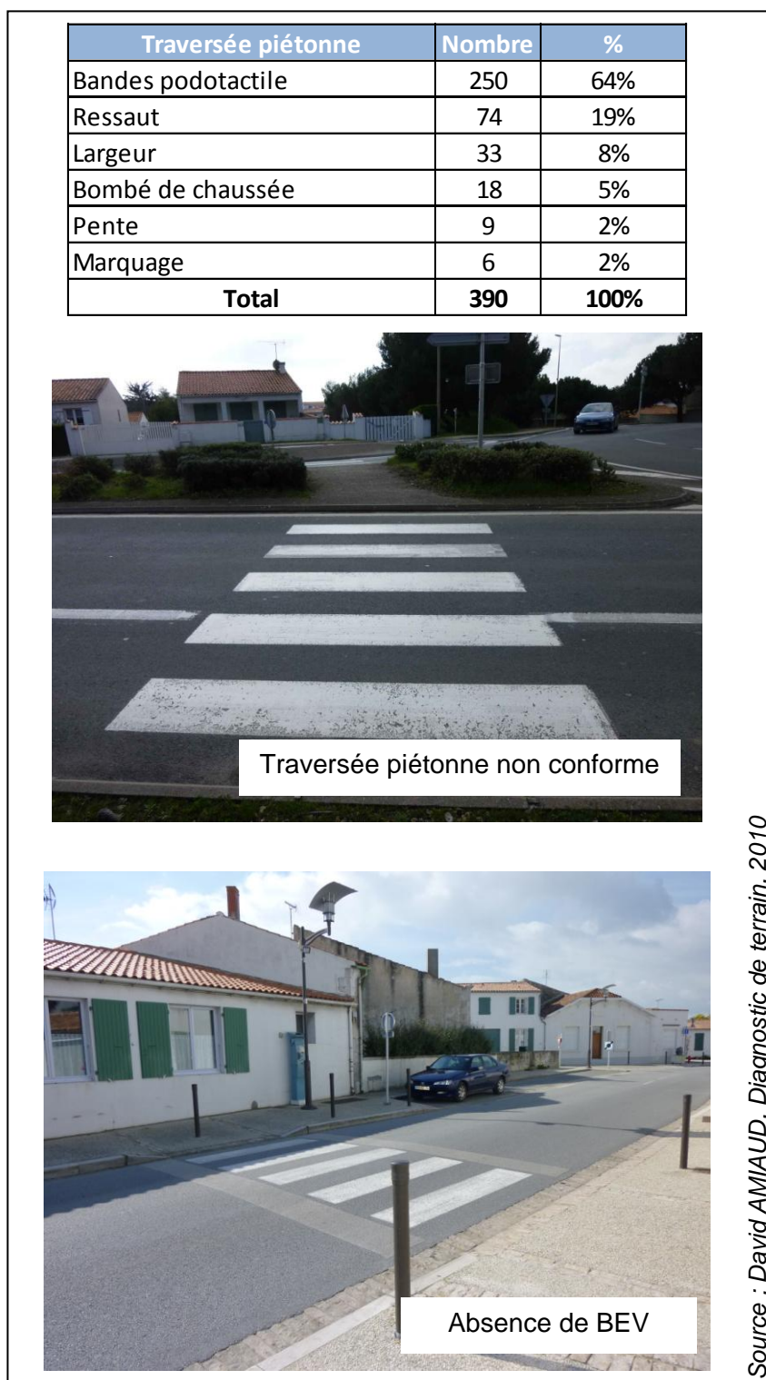
Figure 16. Nature des obstacles sur les traversées piétonnes à Rivedoux-Plage en 2010
