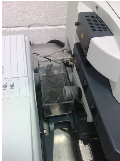
Figure 4.25 – Liaison périscope pour coupler le microscope et le spectromètre en mode émission. les deux miroirs plans permettent de conserver le faisceau collimaté sortant du microscope et arrivant à l'entrée de l'interféromètre.
