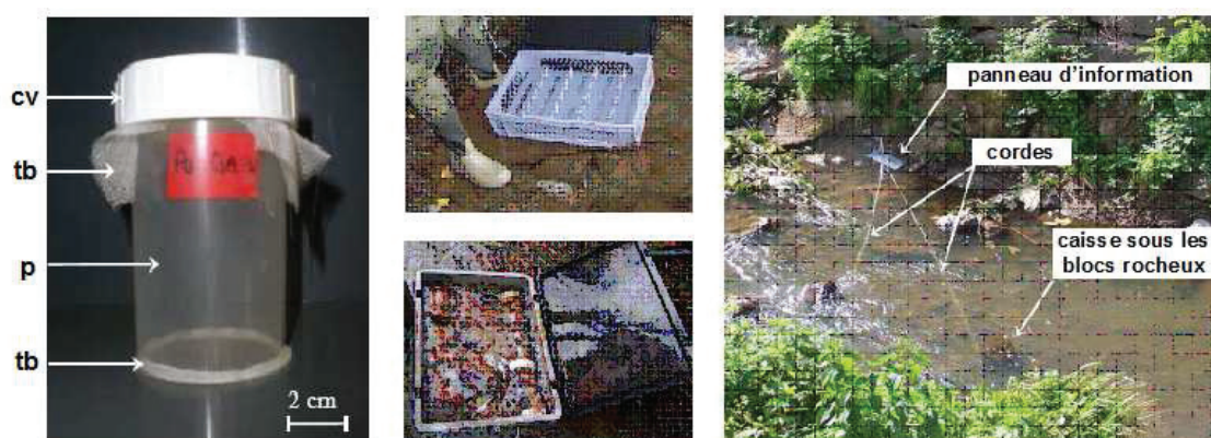
Figure 2.10. Matériels et méthodes d'encagement sur le terrain avec de gauche à droite : la chambre d'encagement, les caisses d'encagement et les systèmes d'encagement dans une rivière installés près de la berge. cv. : couvercle vissé ; p. : pot en polypropylène étiqueté ; tb. : toile à bluter
