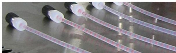
FIGURE 2.14: Méthode de stockage de gouttes en millifluidique
