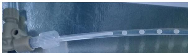
FIGURE 2.13: Méthode de génération de gouttes en millifluidique
