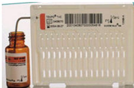
FIGURE 1.16: Carte d'analyse du système TEMPO<sup>(R)</sup>.
