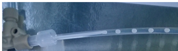
FIGURE 2.13: Méthode de génération de gouttes en millifluidique
