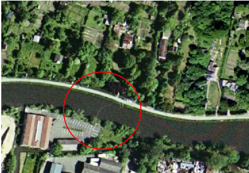
FIGURE A.2 – Effet d'une poussière sur l'optique pour une image aérienne, bien visible au niveau du cours d'eau. Caméra argentique, IGN.
