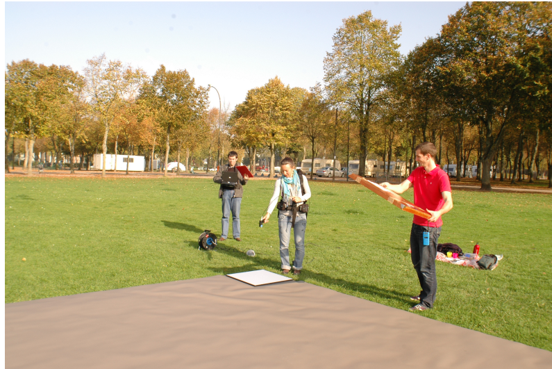
FIGURE 6.3 – Mesures de luminance à l'aide d'un spectroradiomètre ASD sur une cible en vinyle dont les propriétés de réflectance sont par ailleurs mesurées en laboratoire. Site d'Amiens, campagne UMBRA.
