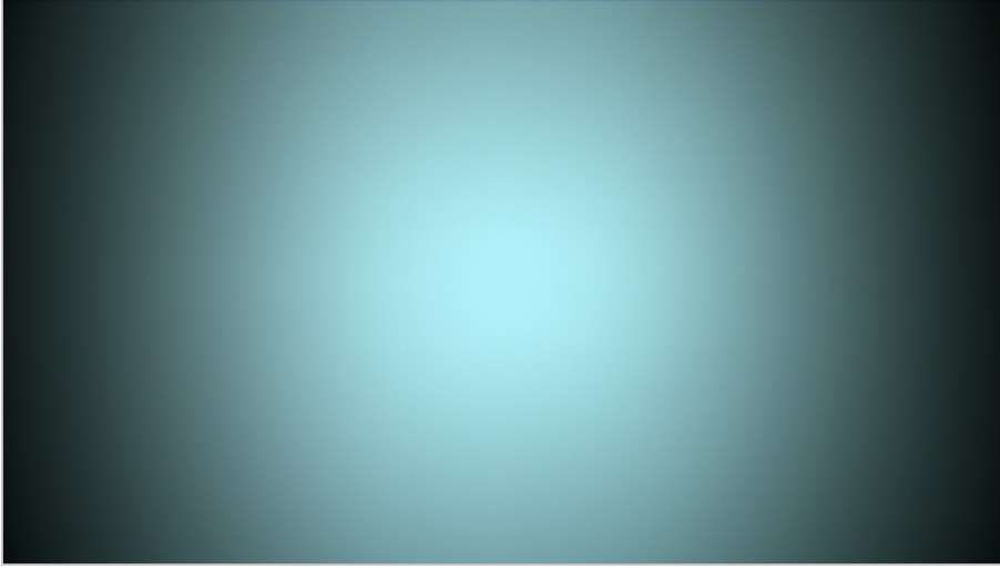
FIGURE A.4 – Exemple de flat-field d'une caméra terrestre (sans correction de la balance des blancs).
