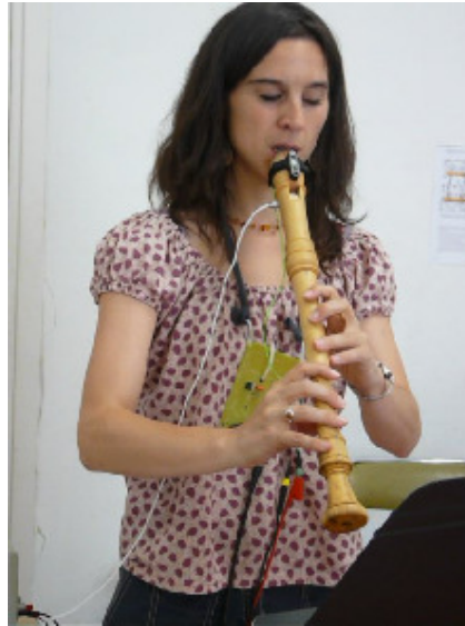
FIGURE 3.1: Dispositif expérimental de mesure sur musicien, permettant de relever la pression d'alimentation P_m dans la bouche via un capillaire, et la pression acoustique à l'intérieur de l'instrument.
