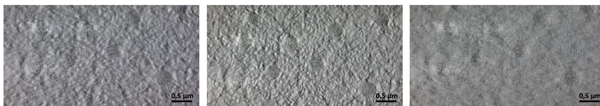
Figure 1-9. Captures d'écran de la tomographie effectuée par TEM sur le film composé de 10 % P3HT – 90 % P(VDF-TrFe) de 360 nm d'épaisseur.
