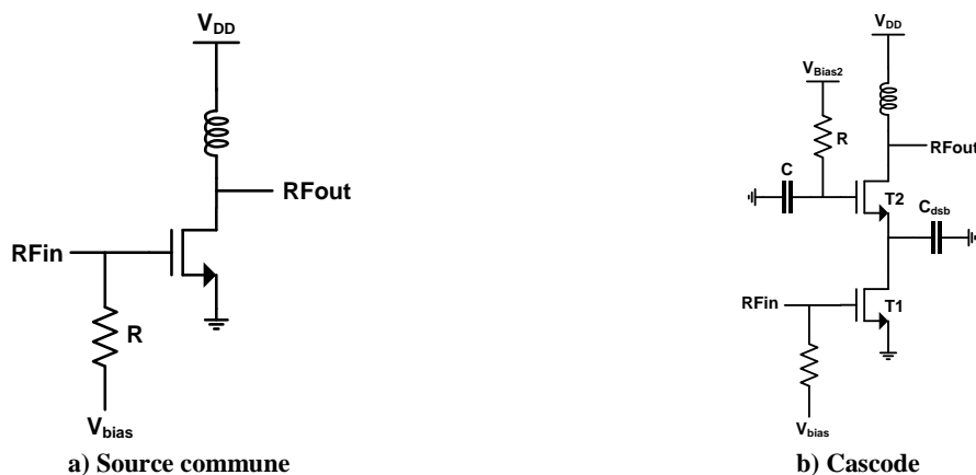
Figure III-7 : Topologies des composants de puissance
