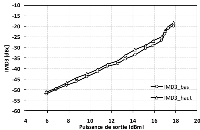
Figure IV-35 : IMD3 en classe A du PA CMOS 65nm
