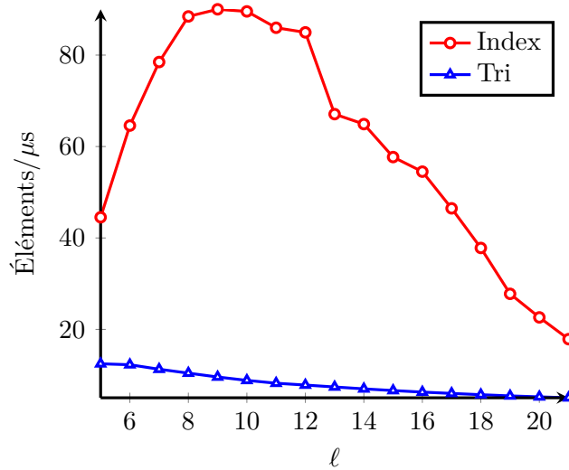
FIGURE 11.2 – Nombre de collisions générées par microsecondes lors de 100 fusions de deux listes de 2^\ell éléments de \ell bits.
