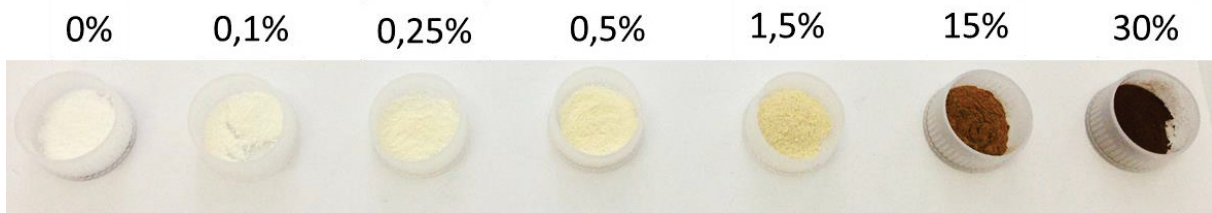
Figure II-17 : Poudres résultant de la synthèse par voie Pechini pour un traitement thermique à 1000°C et différents pourcentages de dopage en manganèse.
