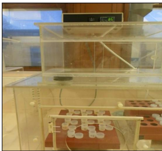
Figure 29 : Evaporation à sec des containers Savillex ouverts sur plaque chauffante
