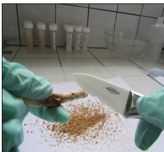
Figure 27 : Prélèvement de 0,5 g de bois sur les derniers cerneaux
