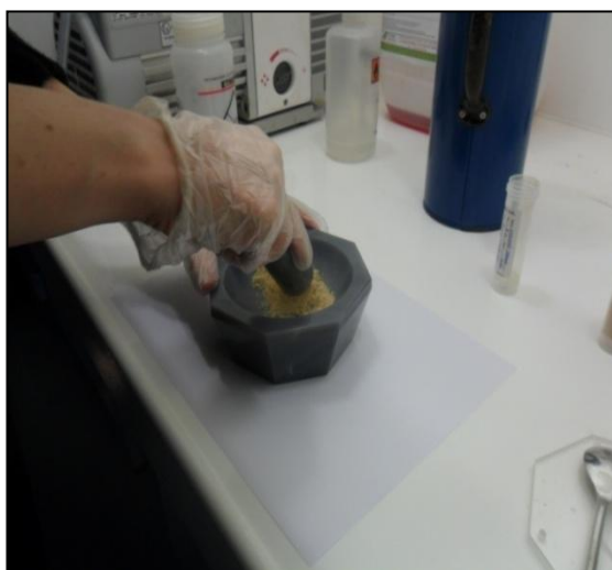
Figure 28 : Broyage après versement d'azote liquide
