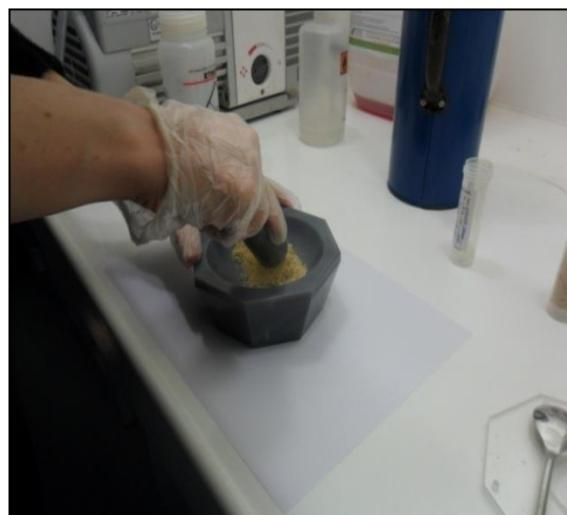
Figure 28 : Broyage après versement d'azote liquide
