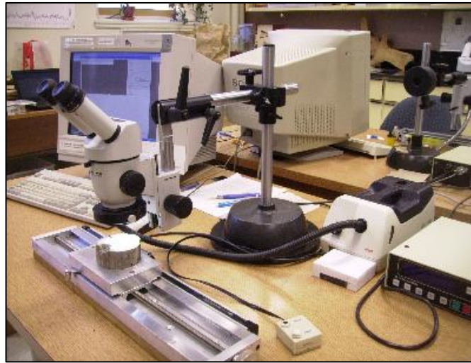
Figure 23 : Mesures des cernes de croissance au micromètre et détection
