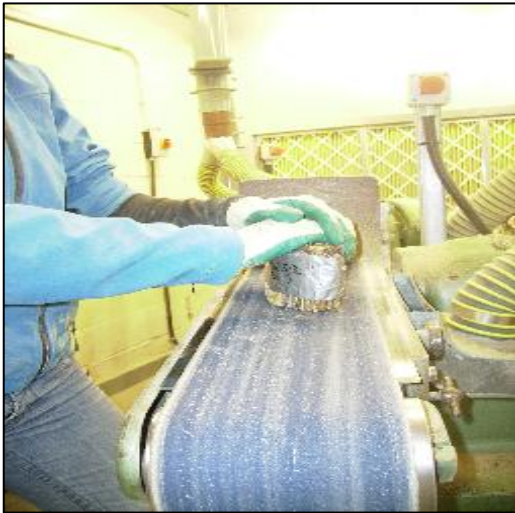
Figure 22 : Ponçage d'un bois flotté des cernes diagnostiques
