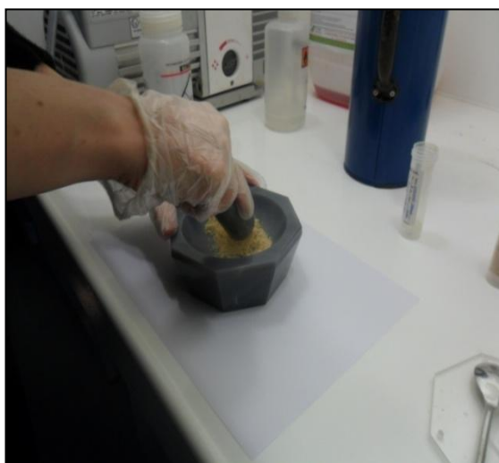
Figure 28 : Broyage après versement d'azote liquide
