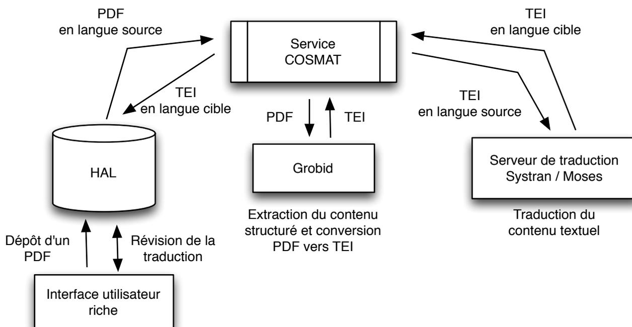
FIGURE 2.5 – Architecture globale du service collaboratif COSMAT intégré dans HAL. Le protocole de communication entre HAL, le serveur GROBID et le serveur de traduction est basé sur une interface « RESTFUL ».
