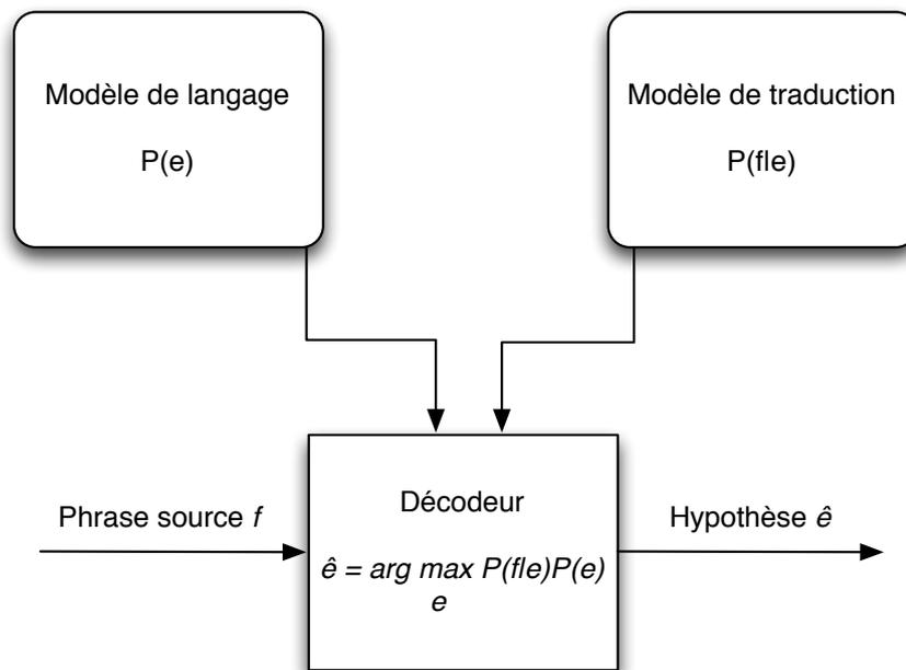
FIGURE 1.2 – Schéma de la traduction automatique statistique.
