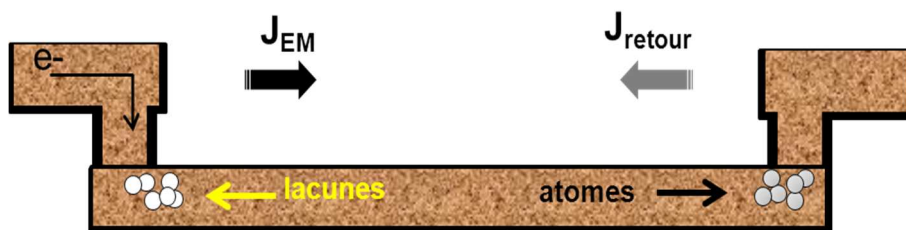
Figure II-6 : flux d'électromigration et flux retour dans une interconnexion
