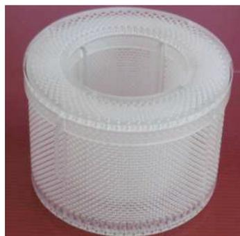
Figure 3. 13 – Panier en PMMA transparent utilisée dans l'étude des vitesses de liquide à l'intérieur du panier.
