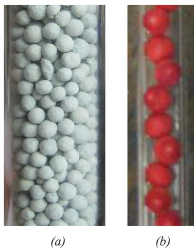
Figure 2. 5 – Exemples de lit de fixe catalyseur dans un réacteur tubulaire :
