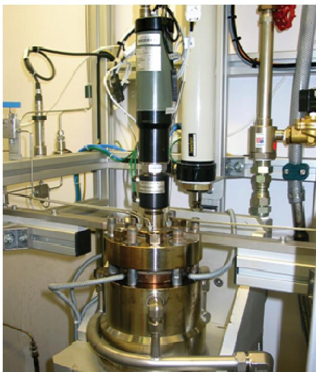
Figure 3. 16 – Réacteur 1, utilisé pour mettre en place les mesures de transfert de matière gaz/liquide et liquide/solide.
