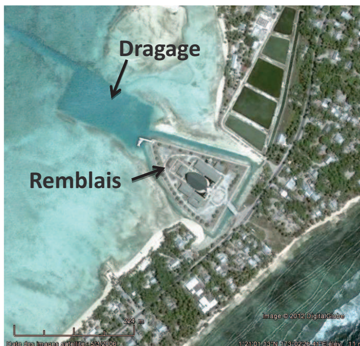
Photographie 4. Image satellite montrant le Parlement de Kiribati construit sur un remblai réalisé par dragage du platier récifal adjacent.
