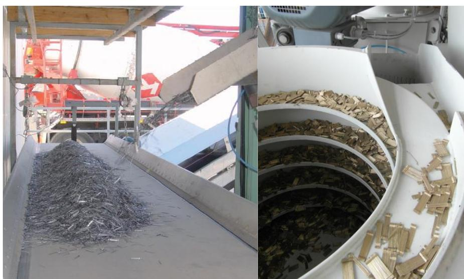
Figure 1.20 : A gauche : tapis roulant servant à convoyer les fibres jusqu'au malaxeur (Source Incite AB) – A droite : silo doseur (CERIB)
