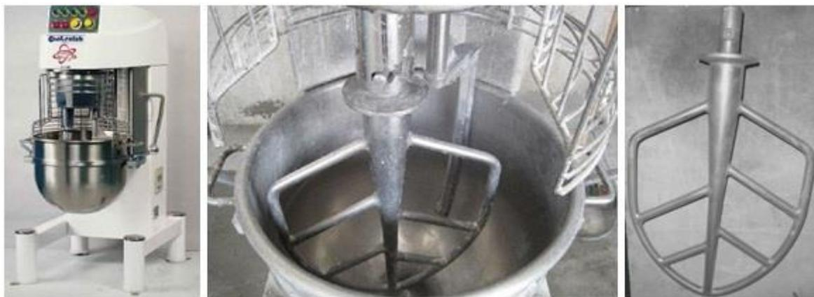
Figure 2.4 : Malaxeur utilisé pour élaborer les coulis
