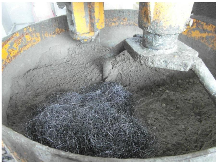
Figure 4.16 : Introduction des fibres en phase sèche
