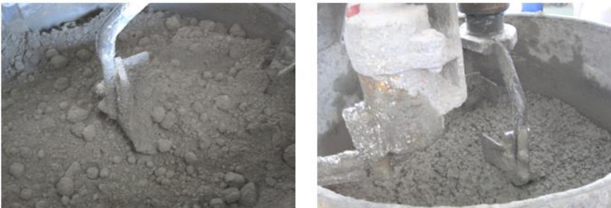
Figure 1.18 : Evolution d'un matériau cimentaire avec l'ajout d'eau : a) phase pendulaire b) état fluide
