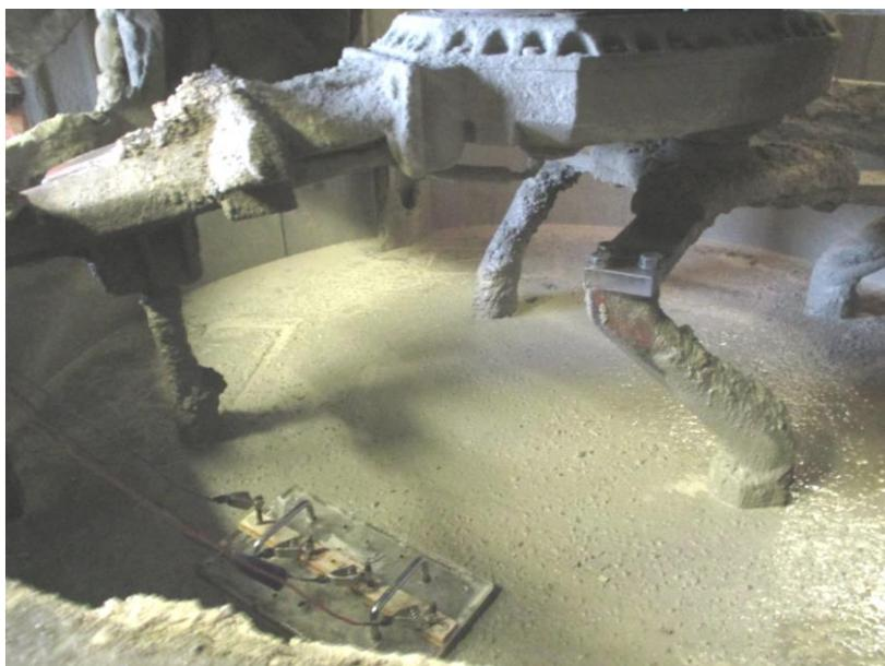
Figure 3.26 : Mesures de résistivité électrique dans un malaxeur industriel de 750 litres (Alkern)
