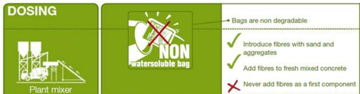
Figure 1.2 : Recommandations concernant le moment d'introduction de fibres métalliques à crochet Dramix, extrait d'un document BEKAERT, Annexe 1.4.5
