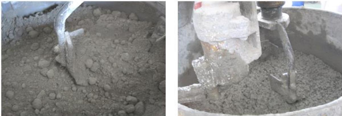
Figure 1.18 : Evolution d'un matériau cimentaire avec l'ajout d'eau : a) phase pendulaire b) état fluide
