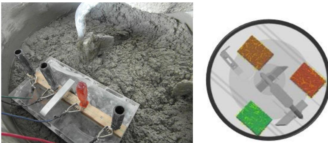
Figure 4.5 : Mesures de résistivité dans la cuve du malaxeur
