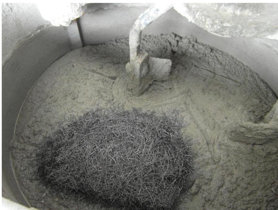
Figure 4.4 : Ajout des fibres dans le malaxeur
