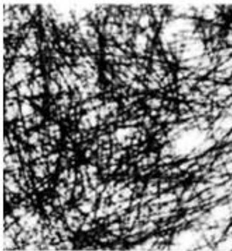
Figure 1.42 : Images radiographiques obtenues avec un signal de 100 kV, 3 mA sur des échantillons d'épaisseur 50 mm [STROEVEN'78a]
