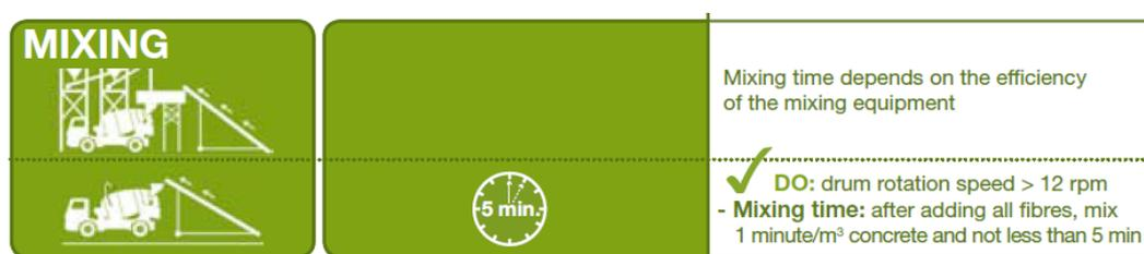
Figure 1.22 : Conseils de Bekaert concernant le malaxage de béton de fibres, Annexe 1.4.5
