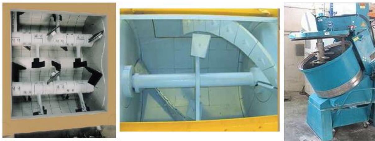
Figure 1.24 : Malaxeurs à axes horizontaux et inclinés, à gauche : deux arbres équipés de pales, au centre, monoarbre à hélice, à droite malaxeur à cuve inclinée
