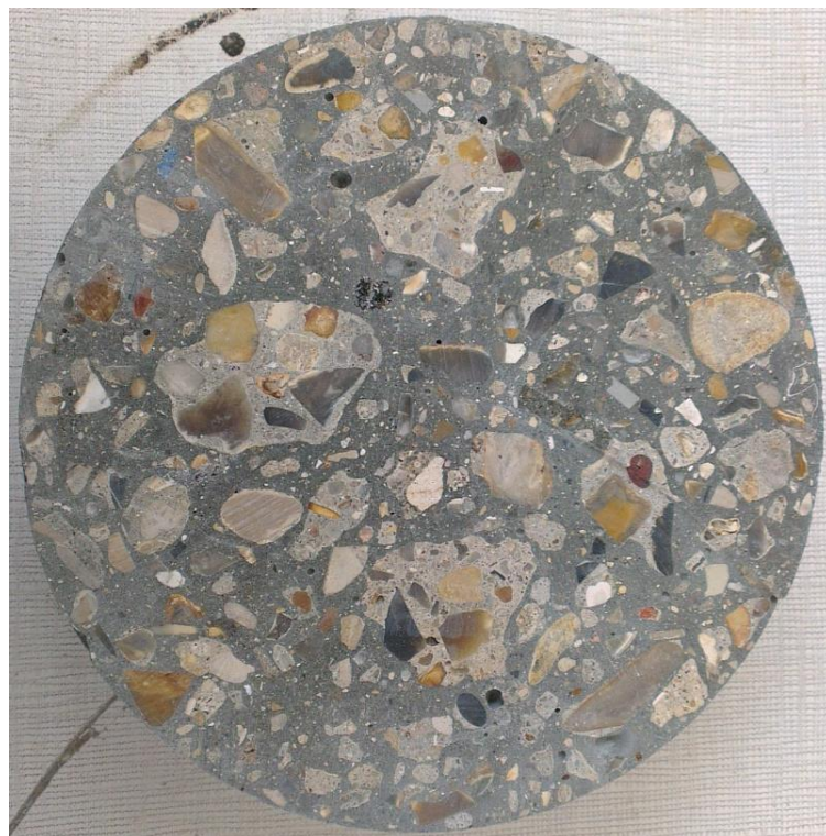
Figure 4-10. BRL 0.3 avant chauffage
