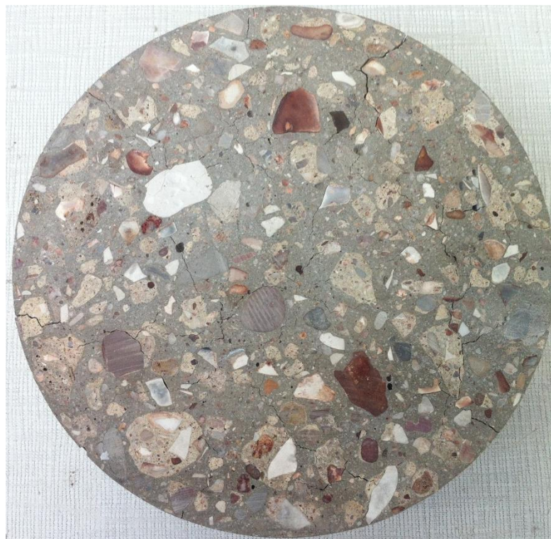
Figure 4-12. BRI 0.3 avant chauffage
