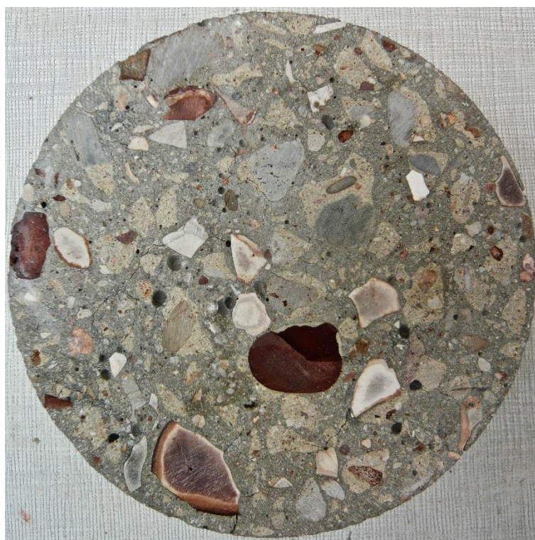
Figure 4-10. BRL 0.3 avant chauffage
