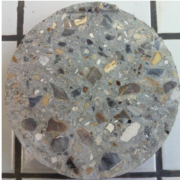
Figure 4-8. BRI 0.6 avant chauffage
