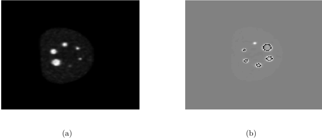
Figure V.6 – Exemple d’images TEP acquises à partir du fantôme NEMA IEC à 6 sphères.
