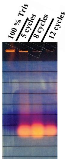
**Figure VI.81** : Gel d'agarose des **QD<sub>602</sub>** en fonction du nombre de cycle de lavage (Agarose 1%, 0.25% bleu de bromphenol et 30% glycerol, Tampon: HEPES 25 mM, Voltage: 30 V, Temps : 2h15)
