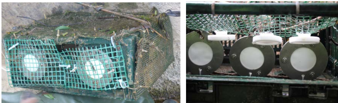
Figure 22 Cagettes prêtes à être posées sur le terrain. Les POCIS sont positionnés face au courant tandis que les DGTs (sur le côté de la cagette) sont placés dans le sens parallèle au courant. Les Chemcatcher sont à l'intérieur de la cagette
