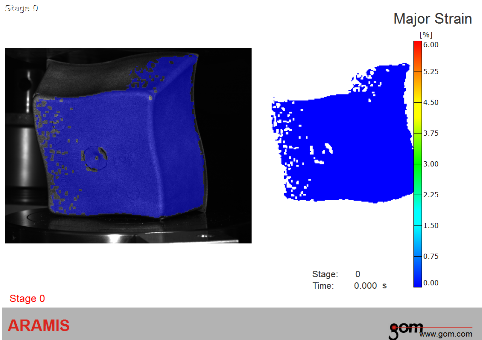
FIGURE 5.28 – Essai de compression statique effectué sur une barquette alimentaire injectée en PHA (Mirel F3002).
