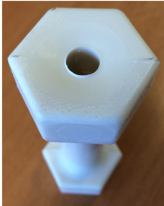
FIGURE 1.19 – Epreuve de Mirel F3002 après perçage.
