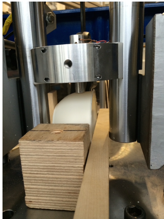
FIGURE 5.29 – Essai préliminaire en dynamique pour simuler la chute d'une structure d'emballage de type bol alimentaire.
