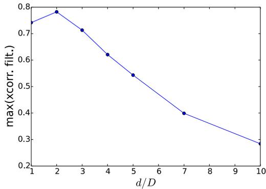
FIGURE 6.40 – Valeur maximum de la corrélation entre la vitesse moyennée sur un profil passant par le moyeu et la position filtrée du sillage sur l'axe  $y$ , pour différents écarts  $d$  du rotor pour le cas  $D=40m$  avec couche limite **modérément** rugueuse
