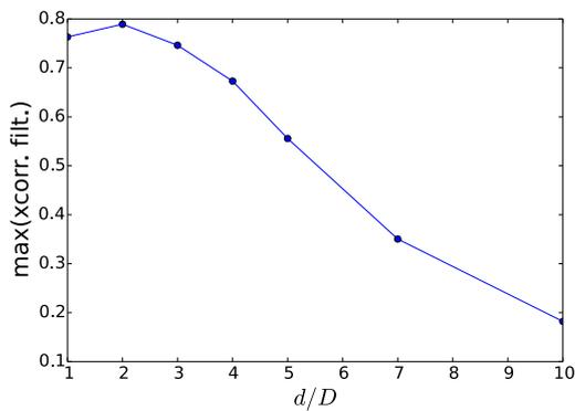
FIGURE 6.42 – Valeur maximum de la corrélation entre la vitesse moyennée sur un profil passant par le moyeu et la position filtrée du sillage sur l'axe  $y$ , pour différents écarts  $d$  du rotor pour le cas  $D=80m$  avec couche limite **faiblement** rugueuse
