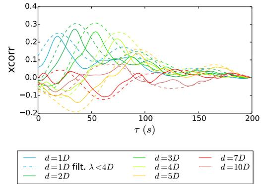
FIGURE 6.21 – Corrélation entre la vitesse moyennée au niveau du moyeu et la position sur l'axe  $y$  du sillage non-filtrée et filtrée au moyen d'un filtre passe bas dont la fréquence de coupure est ajustée de sorte à correspondre à une longueur d'onde  $\lambda_c = 4D$  selon l'hypothèse de Taylor
