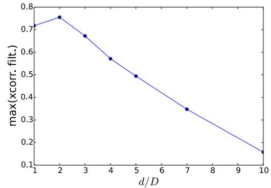
FIGURE 6.41 – Valeur maximum de la corrélation entre la vitesse moyennée sur un profil passant par le moyeu et la position filtrée du sillage sur l'axe  $y$ , pour différents écarts  $d$  du rotor pour le cas  $D=80m$  avec couche limite **modérément** rugueuse
