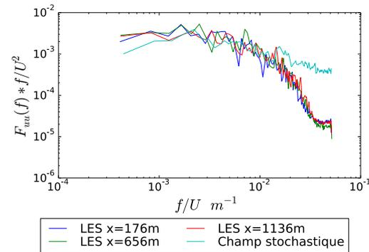
FIGURE 4.27 – Spectres temporels de la vitesse longitudinale à différentes positions dans le domaine, à une altitude  $z = 40m$  pour le cas avec maillage **normal** et couche limite **modérément** rugueuse
