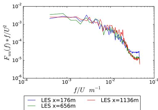
FIGURE 4.28 – Spectres temporels de la vitesse longitudinale à différentes positions dans le domaine, à une altitude  $z = 40m$  pour le cas avec maillage **normal** et couche limite **faiblement** rugueuse
