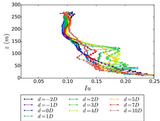
FIGURE 6.31 – Profils verticaux d’intensité turbulente pour le cas  $D=80m$  avec couche limite **fortement** rugueuse
