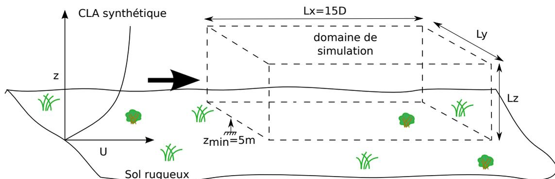
FIGURE 4.7 – Schéma du domaine de simulation
