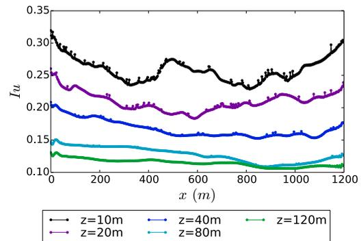
FIGURE 4.23 – Profils longitudinaux de  $I_u$  pour le cas avec maillage **normal** et couche limite **fortement** rugueuse
