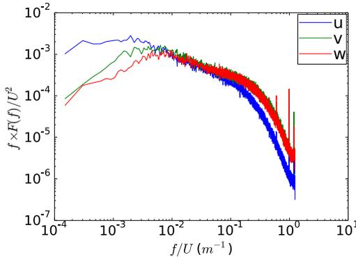
FIGURE 2.12 – Densité spectrale de puissance de la vitesse de la CLA modérément rugueuse
