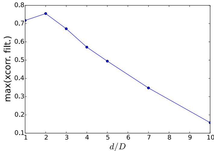
FIGURE 6.23 – Valeur maximum de la corrélation entre la vitesse moyennée sur un profil passant par le moyeu et la position filtrée du sillage sur l'axe  $y$ , pour différents écartements  $\Delta x$  du rotor
