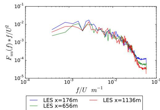
FIGURE 4.29 – Spectres temporels de la vitesse longitudinale à différentes positions dans le domaine, à une altitude  $z = 40m$  pour le cas avec maillage **normal** et couche limite **fortement** rugueuse
