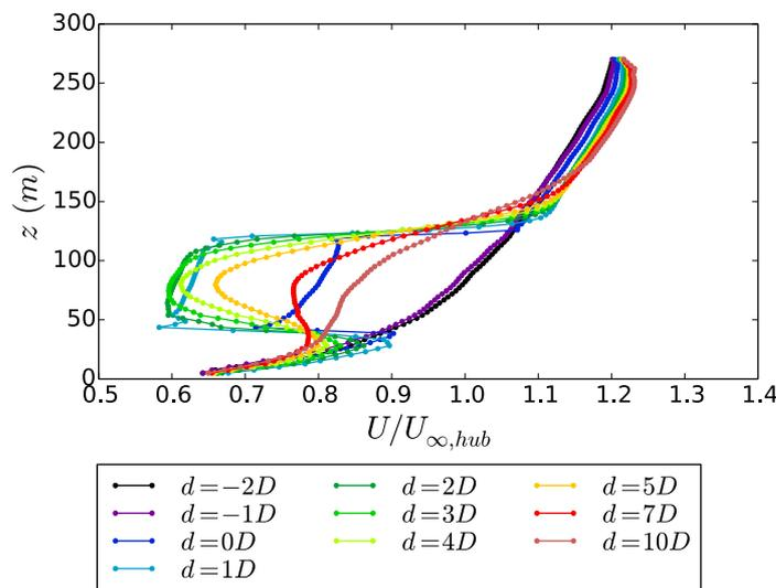
FIGURE 6.7 – Profils verticaux de vitesse moyenne longitudinale à différentes positions sur l'axe  $x$
