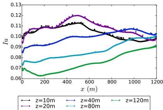
FIGURE 4.22 – Profils longitudinaux de  $I_u$  pour le cas avec maillage **normal** et couche limite **faiblement** rugueuse
