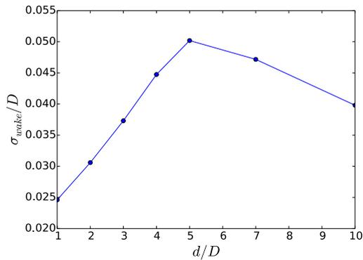
FIGURE 6.38 – Écart type de la position verticale du sillage pour le cas  $D=80m$  avec couche limite **faiblement** rugueuse
