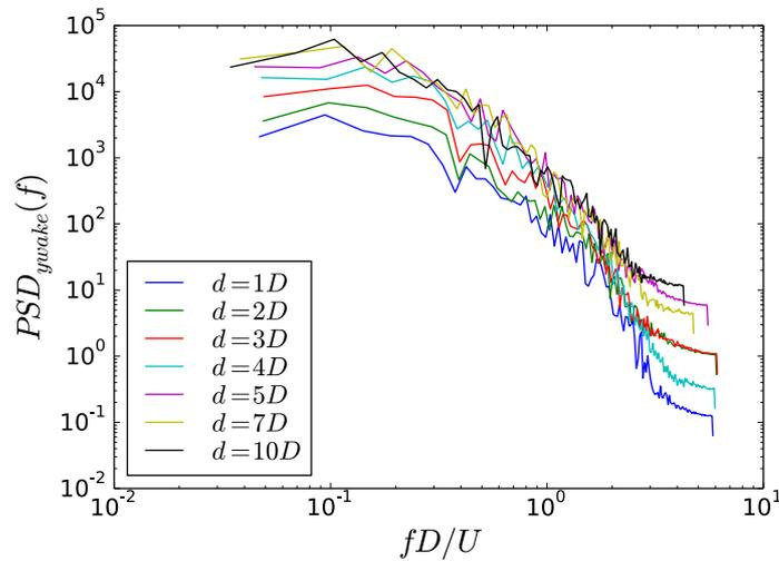
FIGURE 6.17 – Densités spectrales de puissance de la position transverse du sillage à différentes positions dans l’axe du moyeu en aval du disque actuateur
