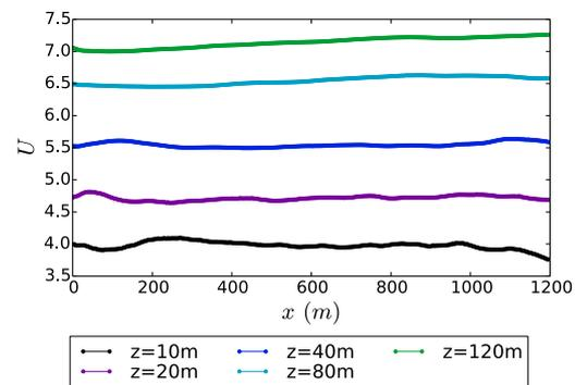
FIGURE 4.15 – Profils longitudinaux de vitesse moyenne pour le cas avec maillage **normal** et couche limite **fortement** rugueuse
