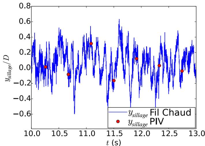
FIGURE 5.6 – Séries temporelles de position du sillage mesurées à partir des données PIV et fil chaud
