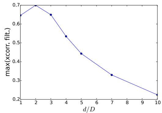
FIGURE 6.43 – Valeur maximum de la corrélation entre la vitesse moyennée sur un profil passant par le moyeu et la position filtrée du sillage sur l'axe  $y$ , pour différents écarts  $d$  du rotor pour le cas  $D=80m$  avec couche limite **fortement** rugueuse
