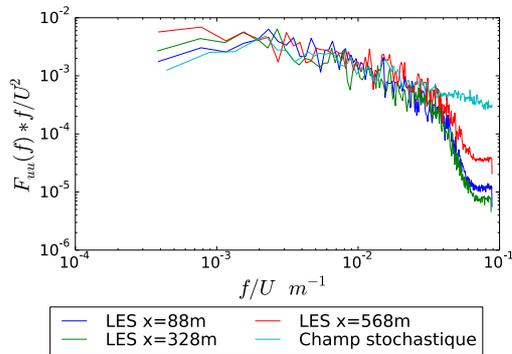
FIGURE 4.26 – Spectres temporels de la vitesse longitudinale à différentes positions dans le domaine, à une altitude  $z = 40m$  pour le cas avec maillage **fin** et couche limite **modérément** rugueuse
