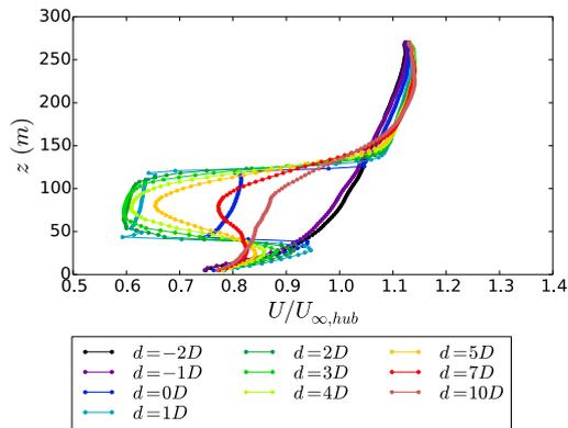
FIGURE 6.26 – Profils de vitesse verticaux pour le cas  $D=80m$  avec couche limite faiblement rugueuse
