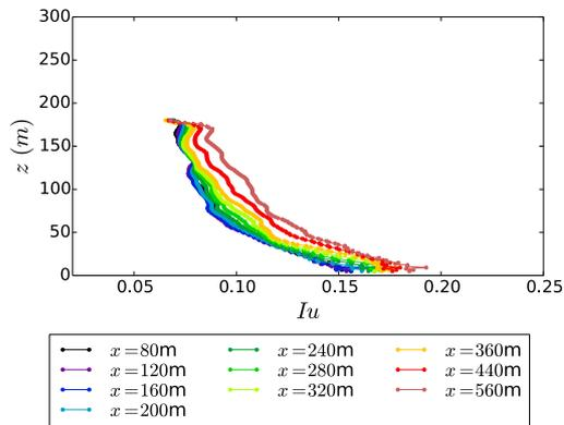
FIGURE 4.16 – Profils verticaux d’intensité turbulente longitudinale pour le cas avec maillage **fin** et couche limite **modérément** rugueuse
