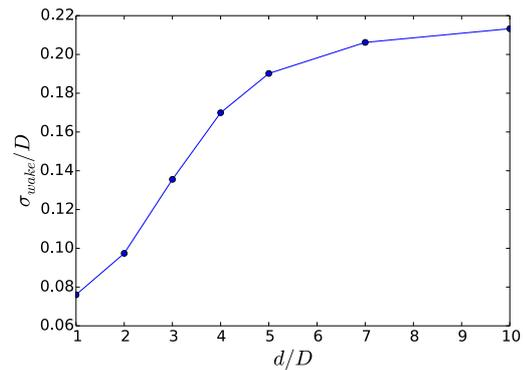
FIGURE 6.35 – Écart type de la position horizontale du sillage pour le cas  $D=80m$  avec couche limite **fortement** rugueuse
