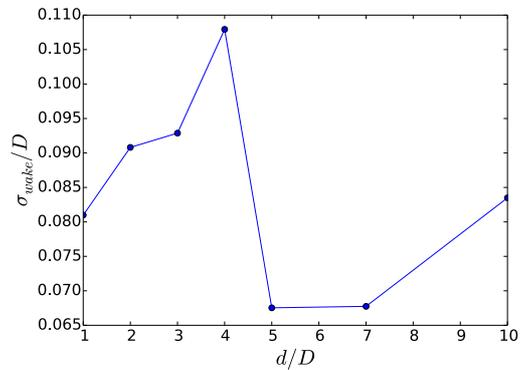
FIGURE 6.39 – Écart type de la position verticale du sillage pour le cas  $D=80m$  avec couche limite **fortement** rugueuse
