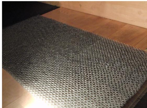
FIGURE 2.4 – Photographie du modèle de couvert forestier poreux
