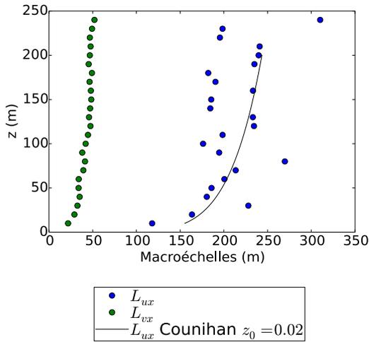
FIGURE 2.8 – Profils d’échelle intégrale longitudinale des composantes  $u$  et  $v$  de la vitesse de la CLA expérimentale modérément rugueuse
