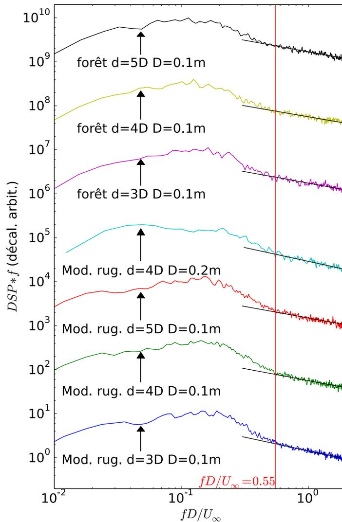
FIGURE 5.12 – Densités spectrales de puissance des séries temporelles de position du sillage mesurées à une distance  $d = 4D$  du rotor pour chaque cas testé
