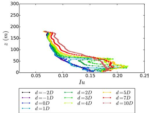
FIGURE 6.28 – Profils verticaux d’intensité turbulente pour le cas  $D=40m$  avec couche limite **modérément** rugueuse
