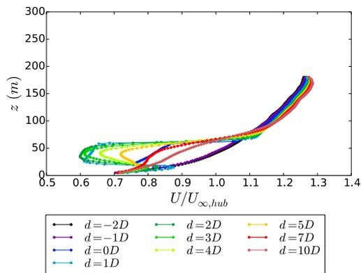
FIGURE 6.24 – Profils de vitesse verticaux pour le cas  $D=40m$  avec couche limite modérément rugueuse
