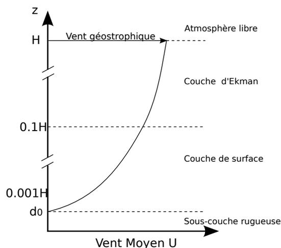
FIGURE 1.2 – Décomposition de la couche limite atmosphérique. Les rapports d'échelles des différentes couches sont des ordres de grandeur.
