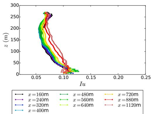
FIGURE 4.18 – Profils verticaux d’intensité turbulente longitudinale pour le cas avec maillage **normal** et couche limite **faiblement** rugueuse
