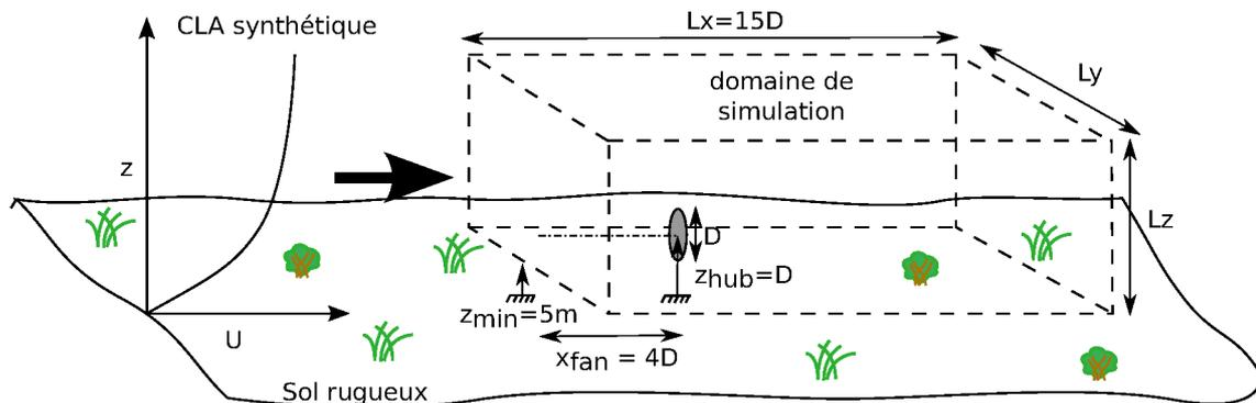
FIGURE 6.1 – Schéma du domaine de simulation
