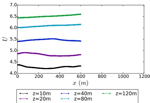
FIGURE 4.12 – Profils longitudinaux de vitesse moyenne pour le cas avec maillage **fin** et couche limite **modérément** rugueuse
