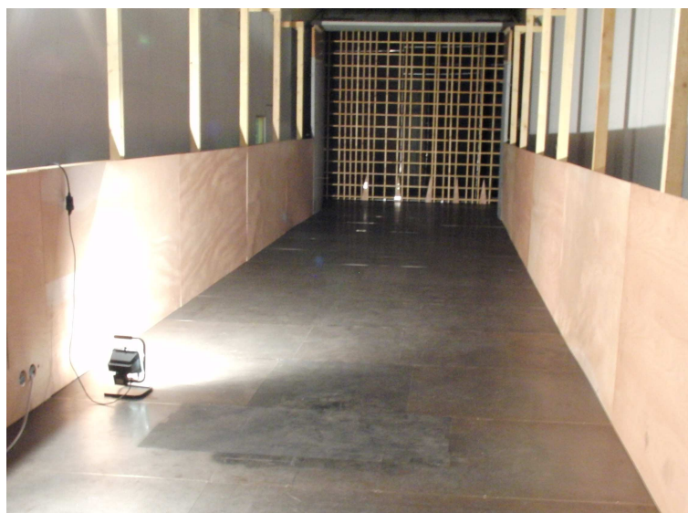
FIGURE 2.2 – Photographie de la veine secondaire de la soufflerie
