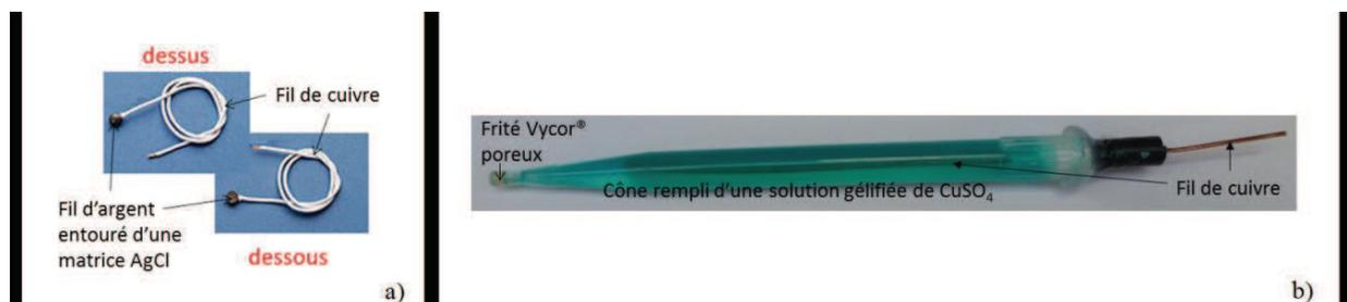
FIGURE V-7 : PHOTO DES DEUX TYPES D'ÉLECTRODES DE POTENTIEL UTILISÉES PENDANT LES EXPÉRINECES BIOPHY. a) ELECTRODES Ag/AgCl DU COMMERCE (WARNER INSTRUMENTS, HAMDEN, USA) ; b) ELECTRODES Cu/CuSO<sub>4</sub> RÉALISÉES À PARTIR DU MODÈLE DE MAINEULT (2004).
