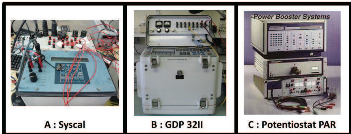
FIGURE V-6 : APERÇU DES APPAREILS UTILISÉS AU LABORATOIRE POUR LES MESURES ÉLECTRIQUES : A/ SYSCAL R1 POUR LA MESURE DE RÉSISTIVITÉ CLASSIQUE ; B/ GDP 32II POUR LES MESURES SIP ET C/ POTENTIOSTAT-GALVANOSTAT (MODÈLE 273A DE PAR) ET ANALYSEUR DE LA RÉPONSE EN FRÉQUENCE (5210 DE PAR) POUR LA SPECTROSCOPIE D'IMPÉDANCE.
